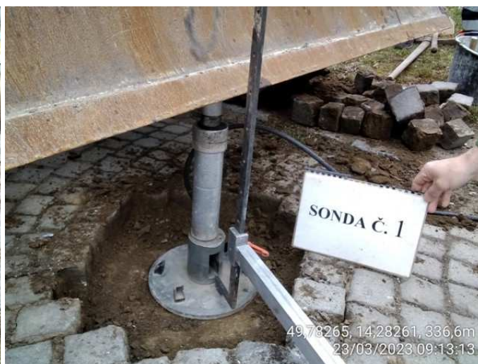
Sonda č.1 – měření konstrukční vrstvy
