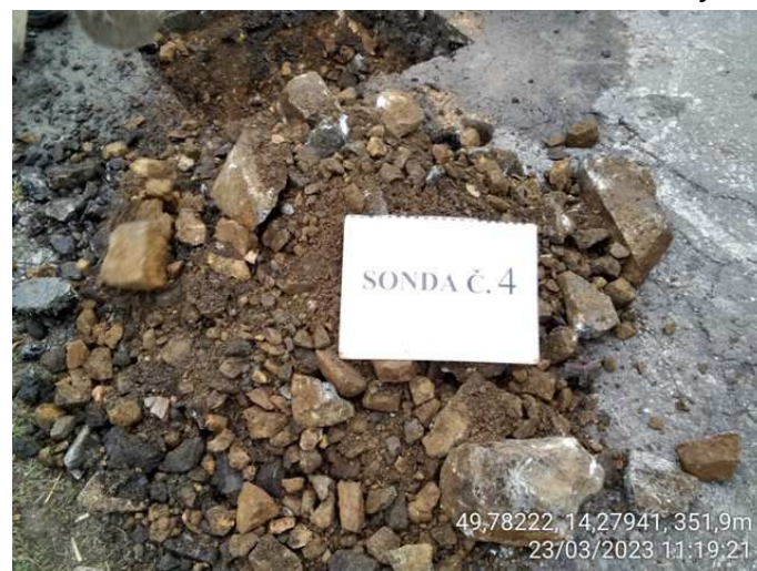
Sonda č.4 – štět a materiál konstrukční vrstvy
