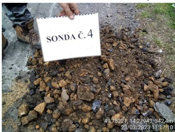
Sonda č.4 – materiál konstrukční vrstvy
