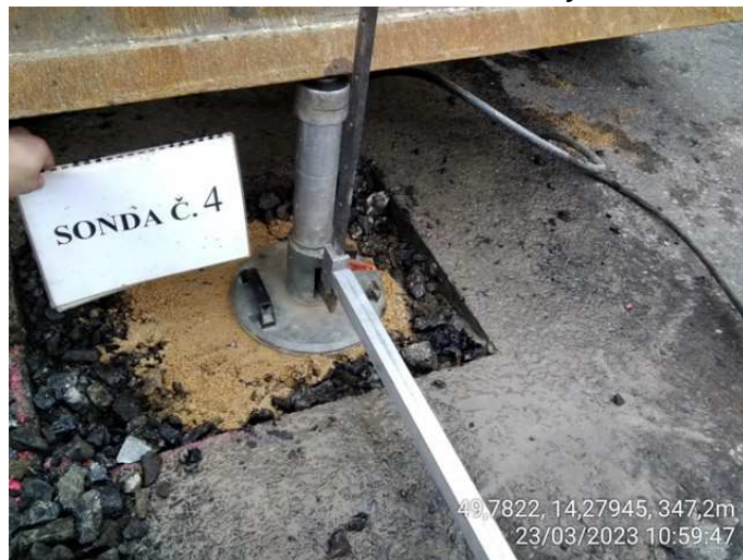
Sonda č.4 – měření konstrukční vrstvy
