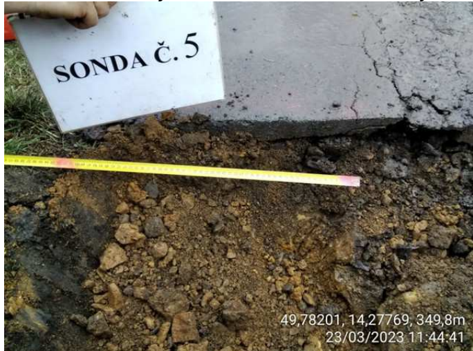
Sonda č.5 – krajnice bez konstrukční vrstvy
