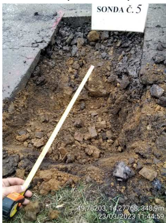
Sonda č.5 – krajnice bez vrstvy štětu
